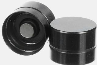
Die Oberfläche der Arbeitsfläche der Ventilstößels wird zuerst vollkommen poliert und danach wird die DLC Schicht aufgetragen. Der Prozess des vollständigen Polierens ist wichtig, damit die DLC Schicht vollkommen mit dem Untergrund verschmilzt. Die Dicke der DLC Schicht ist 2-5 µm. Die erreichte Härte ist danach mehr als 2000 HV.
